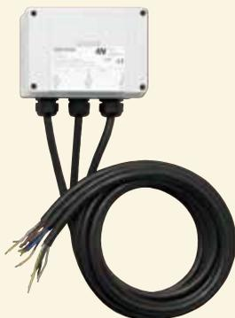
Anschluss-Set für den elektrischen Anschluss eines DE 13 KE, umschaltbar oder DE 13 KE TOP, umschaltbar an eine Herdanschlussdose. Die integrierte Vorrangschaltung unterbricht kurzfristig die Stromversorgung für den Elektroherd für die Zeit der Warmwasserzapfung.
