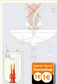
Die neue Thermo Stop-Technologie spart bis zu 0,4 kWh/24 h Energie!
